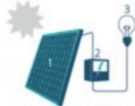
1. Zonnepaneel | 2. Omvormer | 3. Elektrische toestellen
