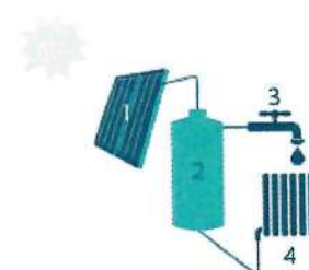
Fig. 2: Zonneboiler met opslagvat, warmwatertap en radiator
