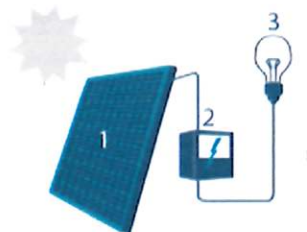
1. Zonnepaneel | 2. Omvormer | 3. Elektrische toestellen
