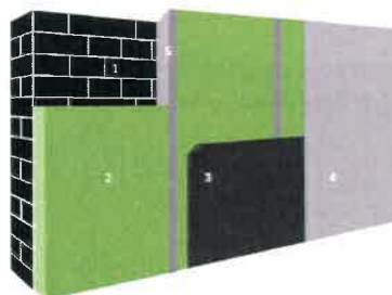
1. Buitengevel | 2. Isolatie | 3. Dampscherm | 4. Binnenafwerking | 5. Stijl- en regelwerk (optioneel)
