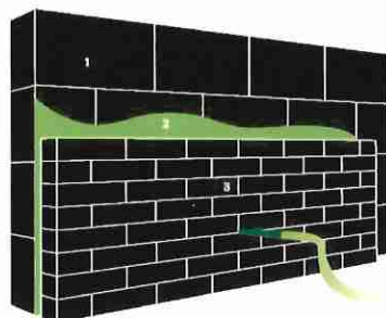
1. Dragende muur | 2. Ingeblazen isolatie | 3. Gevelsteen / gevelbekleding
