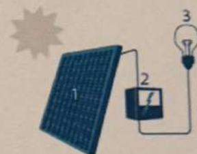
1. Zonnepaneel | 2. Omvormer 3. Elektrische toestellen
