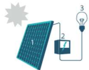
1. Zonnepaneel | 2. Omvormer | 3. Elektrische toestellen
