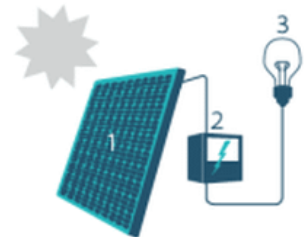
1. Zonnepaneel | 2. Omvormer | 3. Elektrische toestellen
