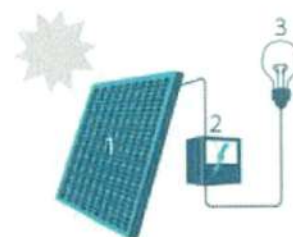
1. Zonnepaneel | 2. Omvormer | 3. Elektrische toestellen
