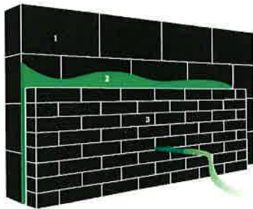
1. Dragende muur | 2. Ingeblazen isolatie | 3. Gevelsteen / gevelbekleding
