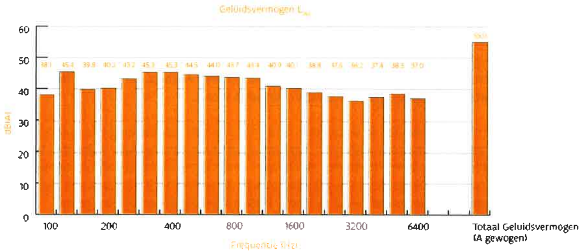
Figuur 6: Abstracte voorstelling van de frequentieverdeling van het geluidsvermogen van een warmtepomp met een tonale component bij een frequentie van 125 Hz.
