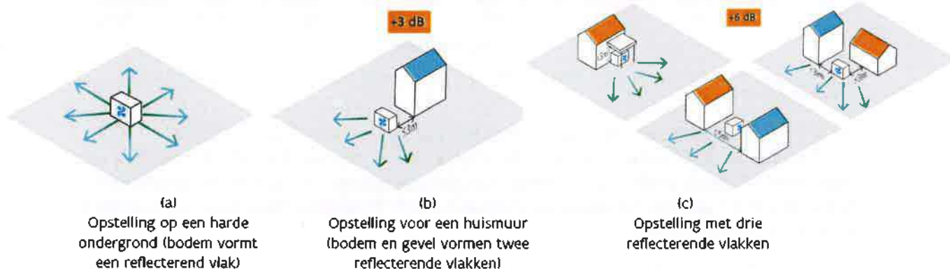
Figuur 3 Opstellingen van buitenunits en de bijhorende reflecties van geluid, (a) een buitenunit zonder obstakels in de buurt maar wel op een harde bodem, (b) een buitenunit geplaatst bij een gevel op een harde bodem, (c) een buitenunit geplaatst bij 2 gevels of een gevel en een afdak op een harde bodem. Dit is een theoretische benadering.
