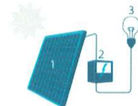
1. Zonnepaneel | 2. Omvormer | 3. Elektrische toestellen
