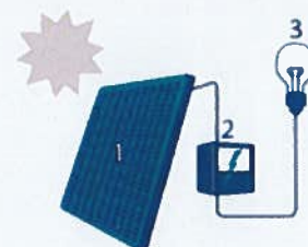
1. Zonnepaneel | 2. Omvormer | 3. Elektrische toestellen
