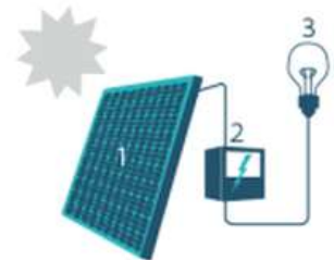
1. Zonnepaneel | 2. Omvormer | 3. Elektrische toestellen
