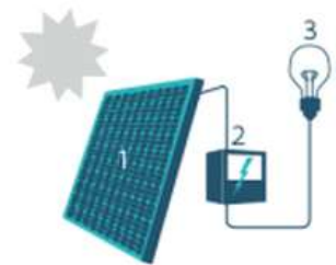
1. Zonnepaneel | 2. Omvormer | 3. Elektrische toestellen
