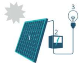
1. Zonnepaneel | 2. Omvormer | 3. Elektrische toestellen
