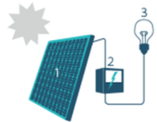
1. Zonnepaneel | 2. Omvormer | 3. Elektrische toestellen
