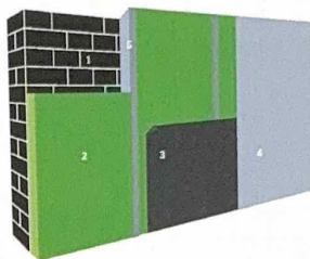
1. Buitengevel | 2. Isolatie | 3. Dampscherm | 4. Binnenafwerking | 5. Stijl- en regelwerk (optioneel)
