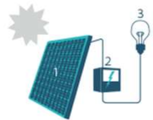
1. Zonnepaneel | 2. Omvormer | 3. Elektrische toestellen
