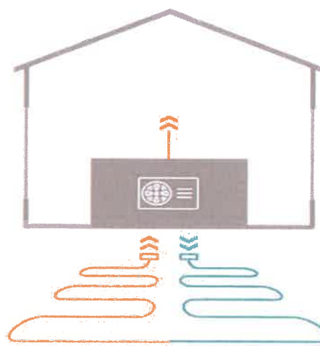
C - BODEM / WATER (HORIZONTAAL)
