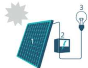
1. Zonnepaneel | 2. Omvormer 3. Elektrische toestellen
