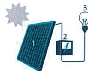
1. Zonnepaneel | 2. Omvormer | 3. Elektrische toestellen
