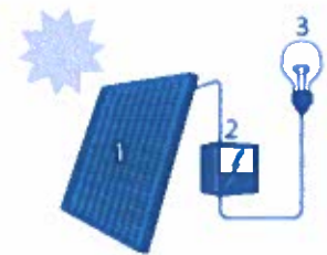
1. Zonnepaneel | 2. Omvormer | 3. Elektrische toestellen
