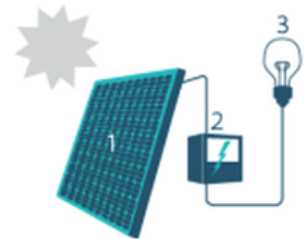
1. Zonnepaneel | 2. Omvormer | 3. Elektrische toestellen
