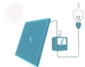
1 Zonnepaneel | 2 Inverter | 3 Elektrische verbruiker
