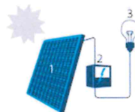
1. Zonnepaneel | 2. Omvormer | 3. Elektrische toestellen
