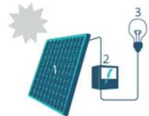
1. Zonnepaneel | 2. Omvormer | 3. Elektrische toestellen
