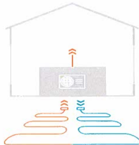
C - BODEM / WATER (HORIZONTAAL)
