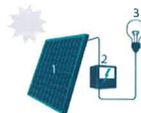
1. Zonnepaneel | 2. Omvormer | 3. Elektrische toestellen
