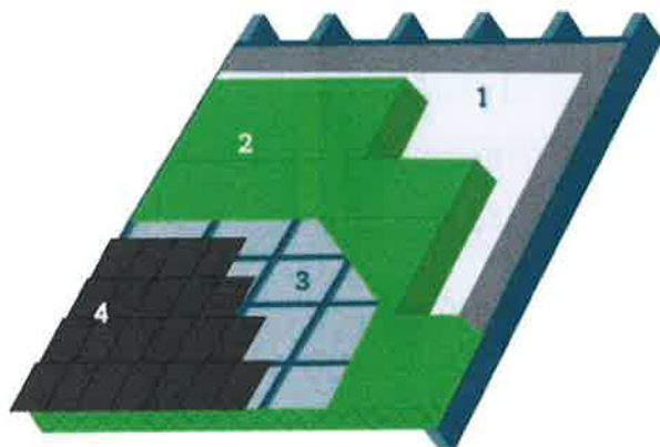
1. Dampscherm | 2. Isolatie | 3. Onderdak | 4. Dakbekleding
