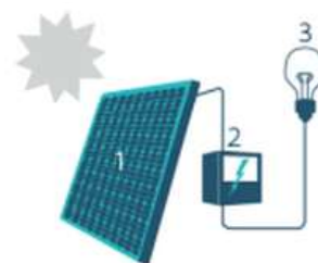
1. Zonnepaneel | 2. Omvormer | 3. Elektrische toestellen
