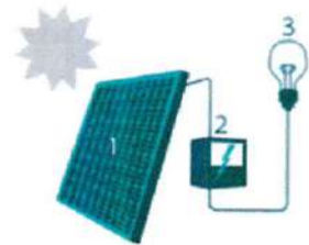
Zonnepaneel | 2. Omvormer 3. Elektrische toestellen
