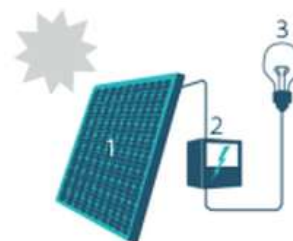
1. Zonnepaneel | 2. Omvormer | 3. Elektrische toestellen
