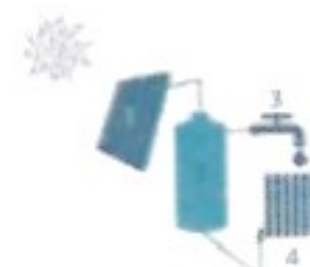
Figuur 14.12: Zonneboiler Zonneboiler op het dak Zonneboiler op het dak Zonneboiler op het dak Zonneboiler op het dak Zonneboiler op het dak Zonneboiler op het dak
