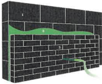
1. Dragende muur | 2. Ingeblazen isolatie | 3. Gevelsteen / gevelbekleding
