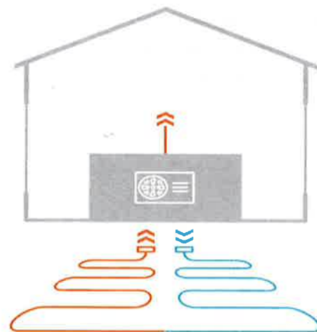
C - BODEM / WATER (HORIZONTAAL)
