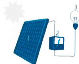
1 Zonnepaneel | 2 Omvormer 3 Elektrische toestel
