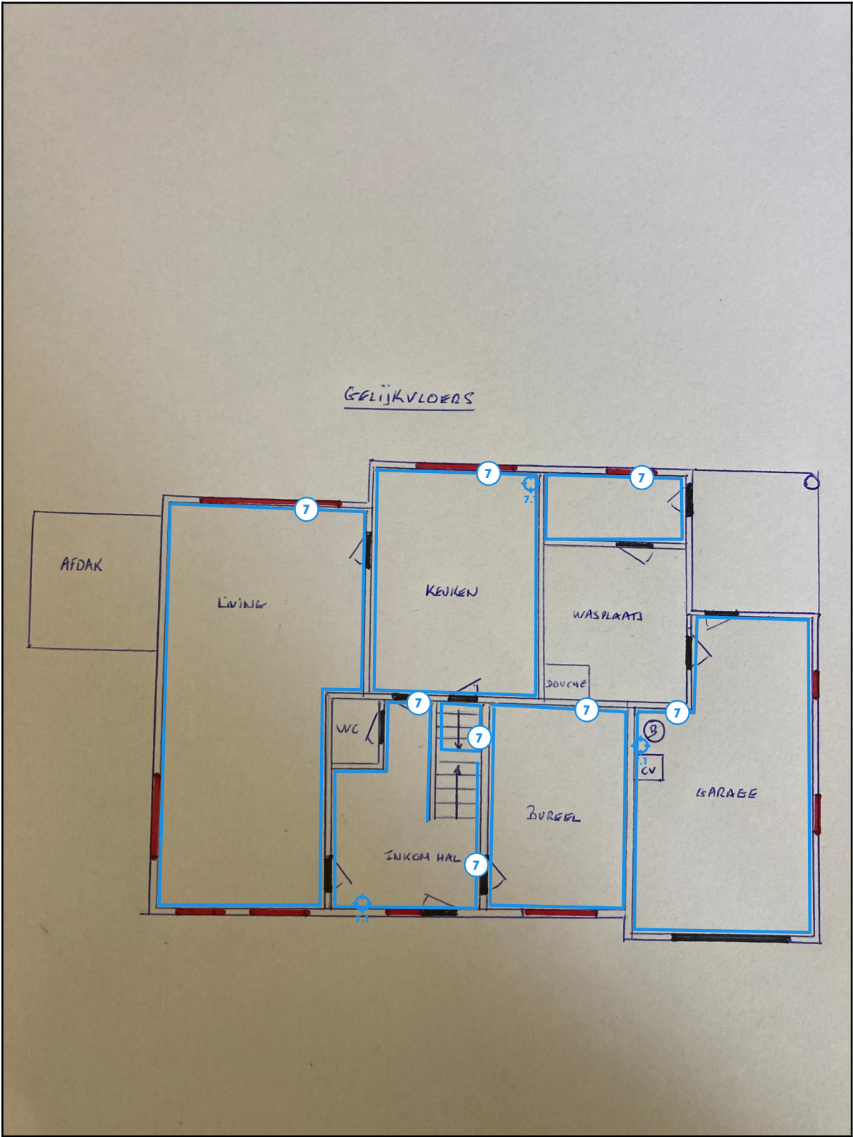
Legende van plan 1.4: gelijkvloers (pleisterwerk muren)
