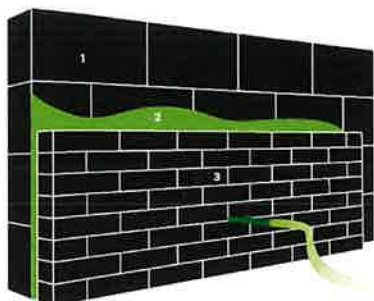
1. Dragende muur | 2. Ingeblazen isolatie | 3. Gevelsteen / gevelbekleding
