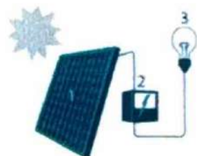
1 Zonnepaneel | 2 Omvormer | 3 Elektrische toestellen
