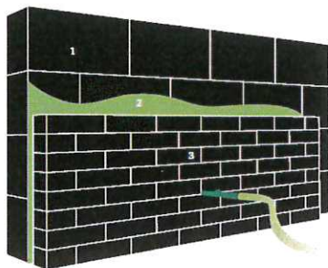
1. Dragende muur | 2. Ingeblazen isolatie | 3. Gevelsteen / gevelbekleding
