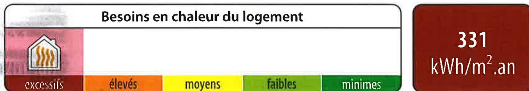
Besoins nets en énergie (BNE) par m<sup>2</sup> de plancher chauffé et par an
