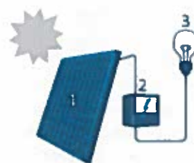
1. Zonnepaneel | 2. Omvormer 3. Elektrische toestellen
