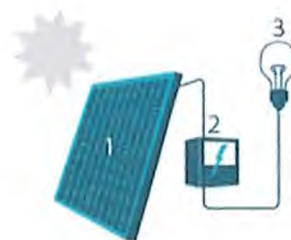
1. Zonnepaneel | 2. Omvormer | 3. Elektrische toestellen
