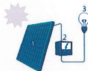
1. Zonnepaneel | 2. Omvormer 3. Elektrische toestellen
