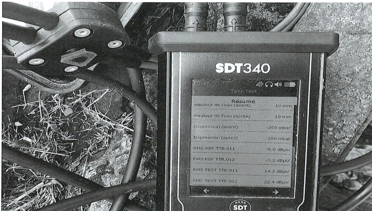
Enregistrement des capteurs avec la fuite calibrée
