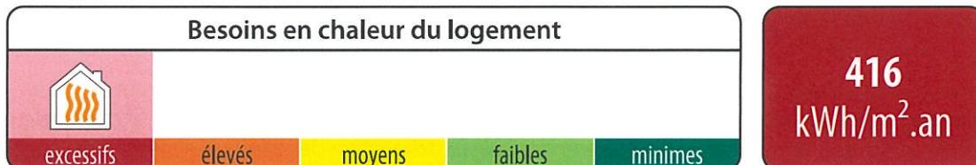
Ces besoins sont les apports de chaleur à fournir par le chauffage pour maintenir constante la température intérieure du logement. Ils dépendent des pertes par les parois selon leur niveau d'isolation thermique, des pertes par manque d'étanchéité à l'air, des pertes par la ventilation mais aussi des apports solaires et des apports internes.
