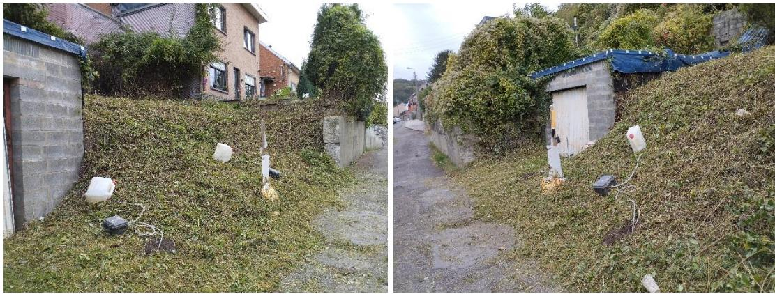
Le pied de sonde est posé à 1m sous le niveau naturel du terrain. Le test s'est déroulé sans soucis apparent. Les résultats donnent les courbes de saturation du sol. La nappe n'est pas visible à la profondeur de 1m.
