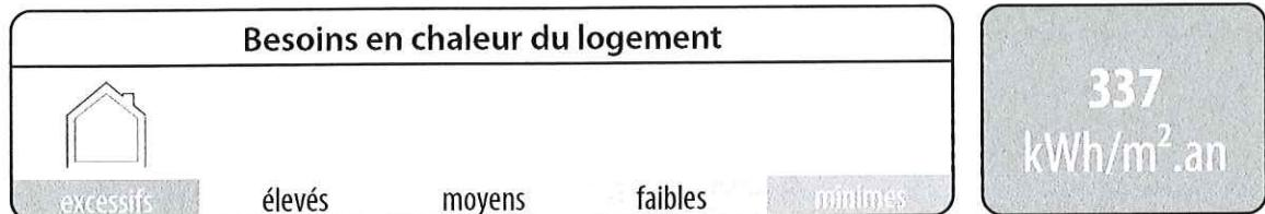
Ces besoins sont les apports de chaleur à fournir par le chauffage pour maintenir constante la température intérieure du logement. Ils dépendent des pertes par les parois selon leur niveau d'isolation thermique, des pertes par manque d'étanchéité à l'air, des pertes par la ventilation mais aussi des apports solaires et des apports internes.
