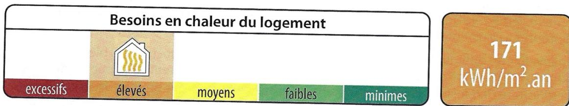
Ces besoins sont les apports de chaleur à fournir par le chauffage pour maintenir constante la température intérieure du logement. Ils dépendent des pertes par les parois selon leur niveau d'isolation thermique, des pertes par manque d'étanchéité à l'air, des pertes par la ventilation mais aussi des apports solaires et des apports internes.
