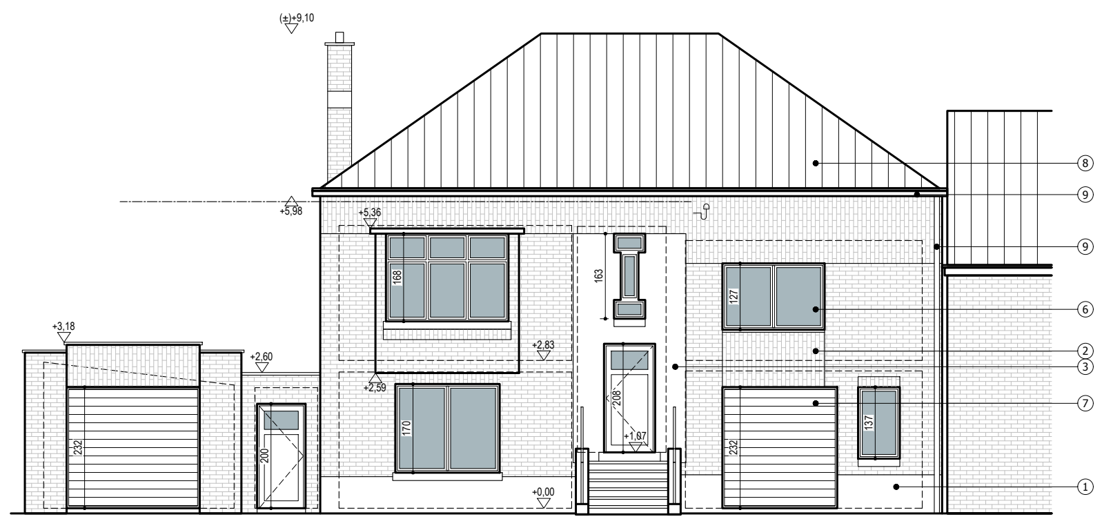
FAÇADE AVANT - ELEVATION NORD Ech.1/100e
